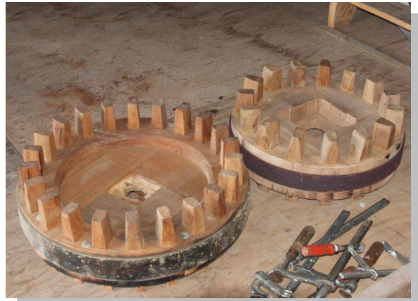
Links het aandrijf wiel van de machineas, Rechts de bovenbonkelaar
