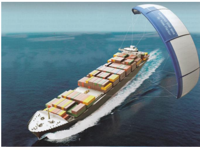
Artist's impression van een containerschip met een kite van 180 m 2 als ondersteunende voortstuwing.
