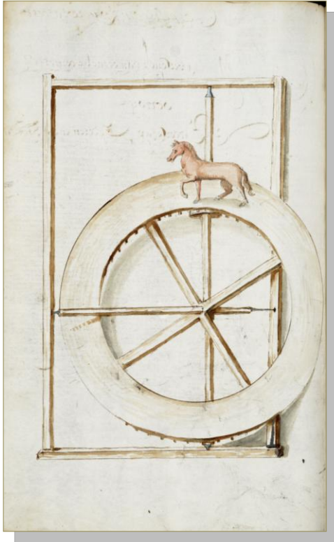
Octrooi van de Staten van Holland van 6 september 1599: de rosmolen met draaischijf.
